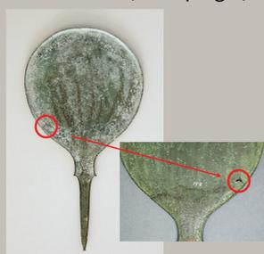
Spannungsrisse, entstanden als Sollbruchstelle des vertikalen Gusses oder durch Überschmieden.
